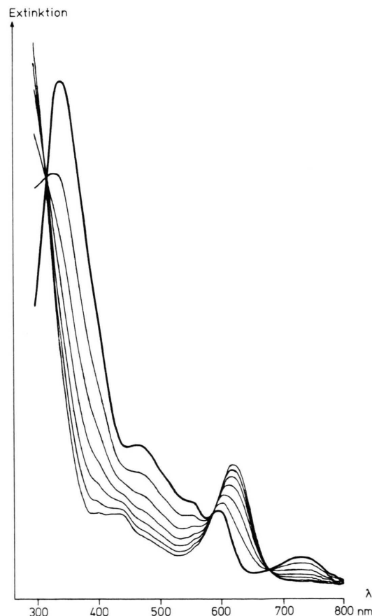
Abb. 2. Änderung des UV/VIS-Spektrums während der Reaktion von Pyridinium – 1 mit KCN; das Spektrum der Ausgangssubstanz ist dick gezeichnet.
